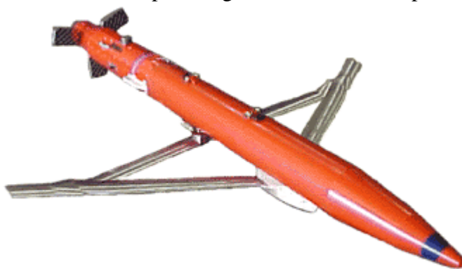
Figur 5.1 Small Diameter Bomb vises her med et wingkit (DiamondBack) som øker rekkevidden til ca. 65 km. SDB er en liten men effektiv bombe som skal kunne passe internt i de nye JSF jagerflyene.
