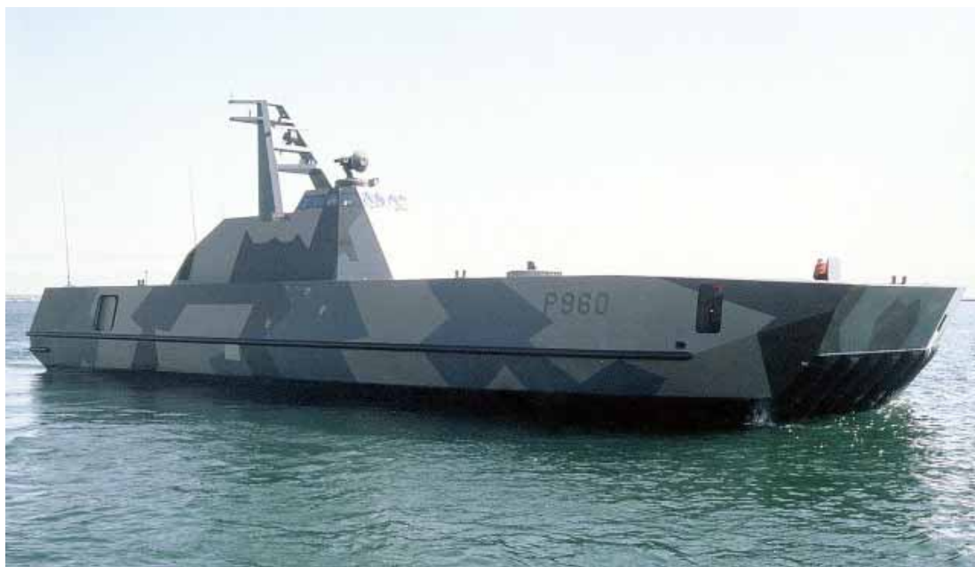
Figur 4.11 Skjold-klasse MTB kan ta opptil åtte NSM-missiler.
